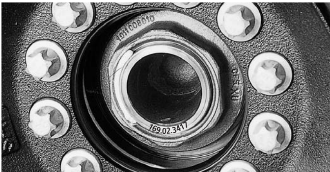
Identification des essieux en cas d'absence de plaque: No. de serie frappe en bout de fusée, côte droit du vehicule.
