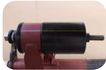
Fig. 14 · Posizione corretta del tubo alloggiamento.
