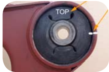
Fig. 17 · Verifica della posizione di montaggio.
