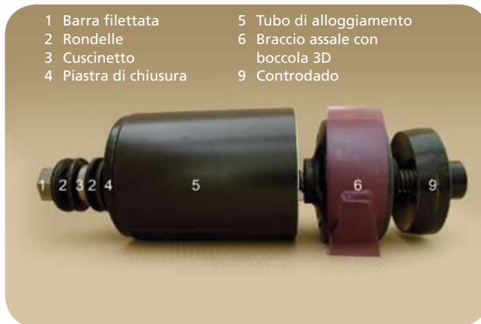
Fig. 1 · Identificazione componenti estrattore
