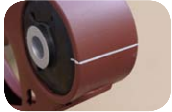
Fig. 5 · Marcatura orientamento boccola
