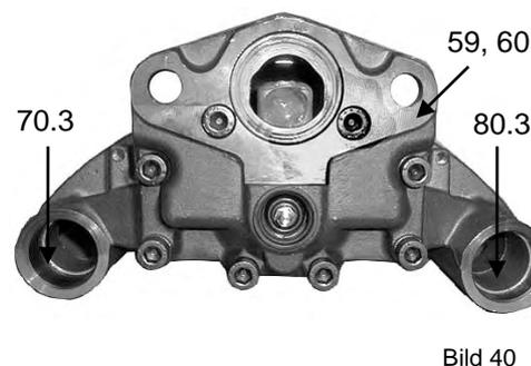
Buchsen 70.3, 80.3 aus Bremssattel 59, 60 mit Presse und Auspressdorn auspressen.
