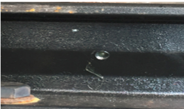
Fig.: 2 - Remove lubrication port
