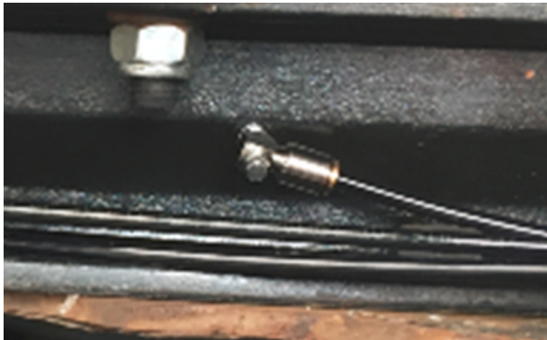
Abb.: 9 - Fettleitungen ablängen
