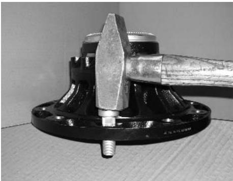
Mit einem Hammer den Radbolzen so weit in den Radflansch einschlagen, bis die Riffelung des Radbolzens greift.
