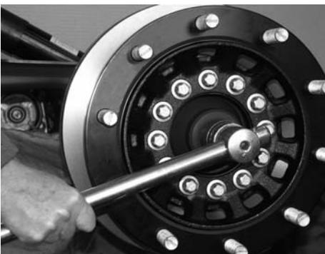
Achsmutter lösen und vom Achsstummel abschrauben.
