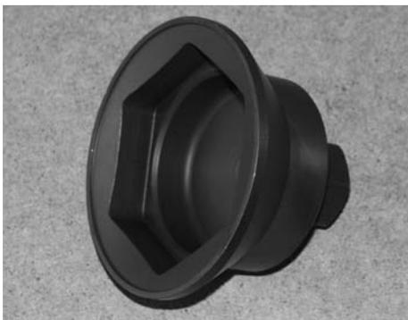
Achsmutterschlüssel SW 85 (Teile-Nr. 4 434 3828 00)
