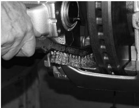
Schächte für die Bremsbeläge reinigen.
