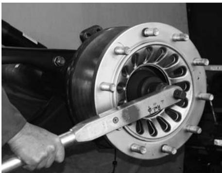
Achsmutter mit vorgeschriebenem Anzugsdrehmoment anziehen und dabei Achskopf um fünf Umdrehungen drehen.
