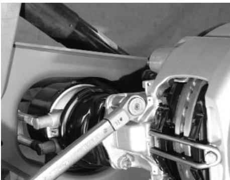
Dichtfläche am Bremssattel überprüfen und falls erforderlich reinigen.
