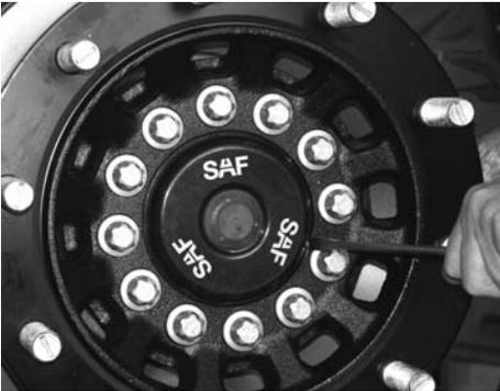
Achskopf SK RB / RLB mit Radflansch und Bremsscheibe ausbauen
