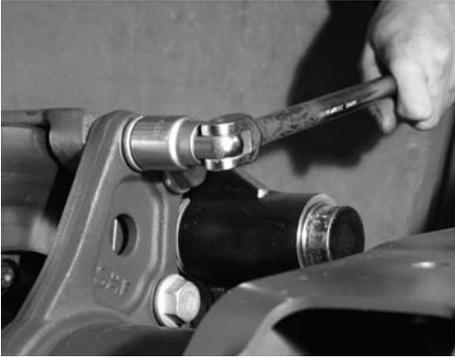
Befestigungsschrauben für den Bremsattel lösen und herausschrauben.
