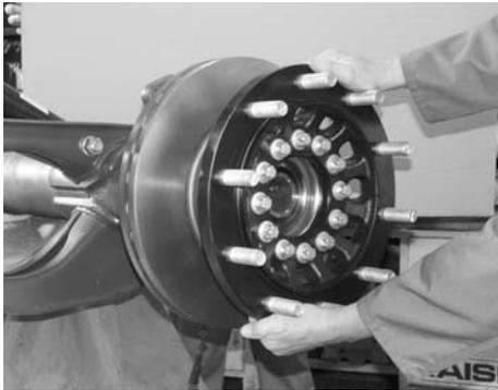
Achskopf SK RB / RLB komplett mit Bremsscheibe vom Achsstummel abziehen.
