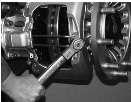
Bremsbelag-Haltebügel in den Bremssattel einsetzen.
