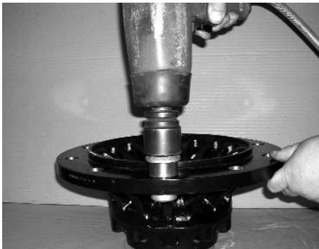
Mit einem Schlagschrauber und einer 32 Nuss den Radbolzen einziehen.
