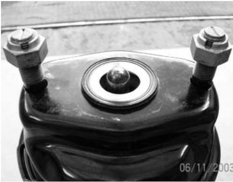
**Bremszylinder an den Bremssattel montieren**
