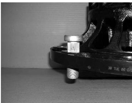
Den Radbolzen in die Bohrung einlegen.
