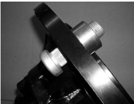
Auf den eingeschlagenen Radbolzen eine ca. 20 mm hohe Distanzhülse (Unterlegscheibe) aufsetzen.
