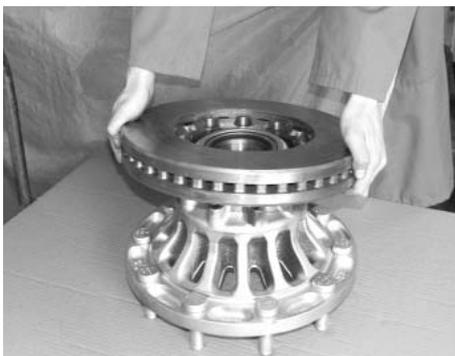
Bremsscheibe auf den Achskopf SK RB *INTEGRAL* aufsetzen und ausrichten.
