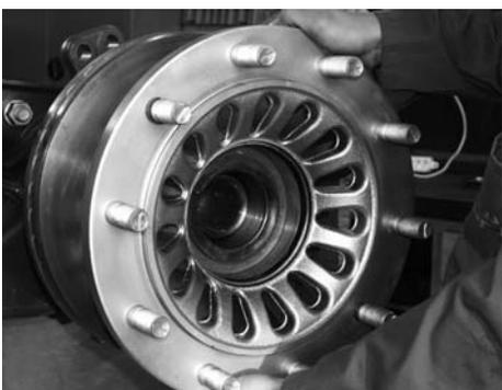
Achskopf SK RB / RLB *INTEGRAL* auf den Achsstummel aufschieben.
