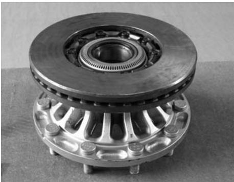
Achskopf SK RB / RLB *INTEGRAL* mit Bremsscheibe an den Achsstummel montieren
