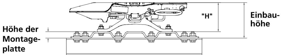
Die Höhe der Sattelkupplung „H“ bemisst sich von der Oberkante der Montageplatte bis zur Oberkante der Sattelplatte. Sie berücksichtigt nicht die Höhe der Montageplatte selbst. Deren Stärke muss zur Höhe „H“ der Sattelkupplung addiert werden und ergibt dann die Einbauhöhe.
