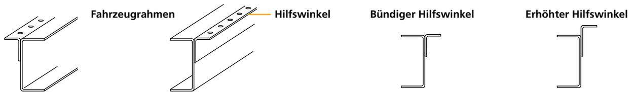
Bei den meisten Fahrzeugen werden die Hilfswinkel als „bündig“ bezeichnet, obwohl sie nicht wirklich mit der Rahmenoberkante fluchten, sondern bis zu 3 oder 4 mm überstehen. Bei manchen Zugmaschinen, in der Regel für den Schwerlasttransport, stehen die Hilfswinkel bis zu 60 mm über dem Rahmen. Die Einbauhöhe bemisst sich demnach von der Oberkante des Hilfswinkels bis zur Oberkante der Sattelkupplung, da Montageplatte oder Verschiebeeinrichtung normalerweise auf dem Hilfswinkel aufliegen.
