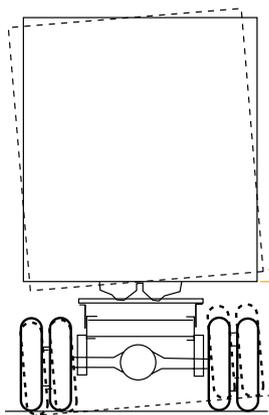
Zwischen Zugmaschine und Trailer ist eine Neigung um die Längsachse bis zu 3 Grad erlaubt. Bei einer Standard-Sattelkupplung ergibt sich dies aus den Toleranzen zwischen Sattelkupplungsplatte und Lagerböcken sowie der Kompression der Gummibuchsen in der Lagerung.
