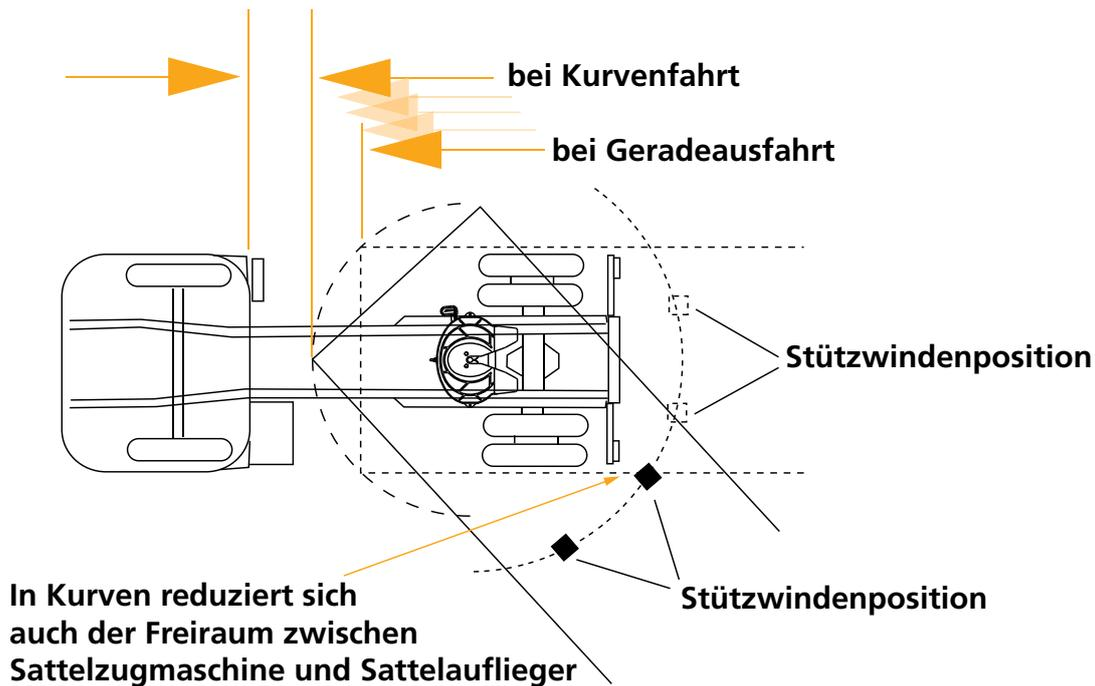
Nicht vergessen: Beim Anfahren an einer Steigung und gleichzeitigem Einlenken reduziert sich der verbleibende Freiraum zwischen Sattelzugmaschine und Sattelaufleger zusätzlich!
