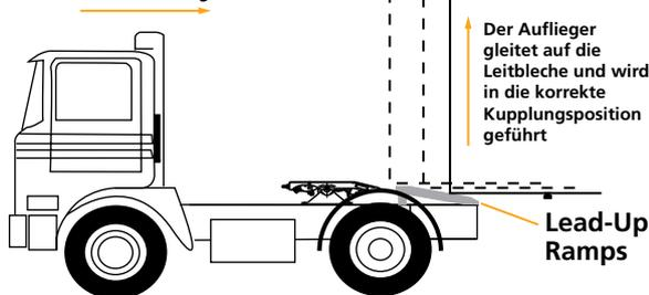
**HINWEIS:** Die Höhe der Lead-Up Ramps ist entscheidend. Sie müssen hoch genug sein, um die Kotflügel zu schützen, aber niedrig genug, um den richtigen Nickwinkel der Sattelkupplung zu ermöglichen. Bei besonders niedriger Einbauhöhe der Sattelkupplung ist der Einbau ggf. nicht möglich.
