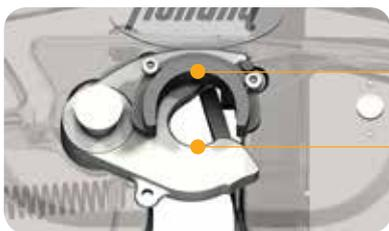
Die Kontaktfläche des Verschleißbrings muss das „Schieben“ abfangen (C)
