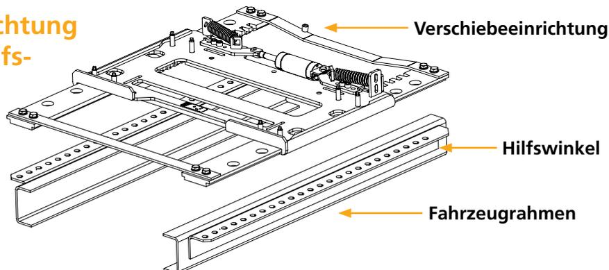
Unsere On Road-Standard-Verschiebeeinrichtung ist für den normalen Straßenbetrieb für bis zu 44 t zulässiges Fahrzeug-Gesamtgewicht und 18 t Sattellast zugelassen. Die Grundplatte ist bereits vorgebohrt, sodass die Verschiebeeinrichtung direkt auf die Hilfswinkel des Zugfahrzeuges geschraubt werden kann, ein separater Hilfsrahmen ist nicht erforderlich.
