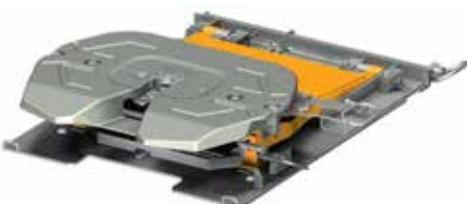
Diese Sattelkupplung wurde speziell für den Volumentransport mit zweiachsigen „Low-Liner-Fahrzeugen“ und „Mega-Trailern“ entwickelt. Die höhenverstellbare Sattelkupplung erlaubt das Anheben der Hubvorrichtung mit Druckluft vor dem Aufsatteln, sodass Sattelaufleger mit unterschiedlichen Kupplungshöhen von ein und derselben Zugmaschine gezogen werden können. Die Hub-Sattelkupplung ist vorgebohrt erhältlich, die für alle europäischen Fahrzeuge passen.
