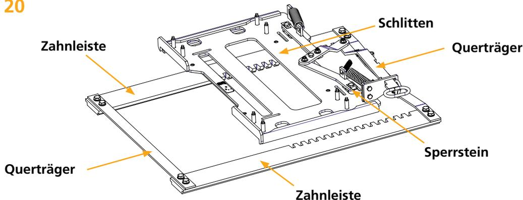
Die Sattelkupplung SK-S 36.20 wird auf dem Schlitten verschraubt, der auf dem Grundrahmen (Zahnleisten + Querträger) vorwärts und rückwärts bewegt werden kann. Die Sperrsteine verriegeln den Schlitten in der gewünschten Position.
