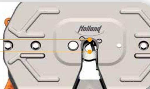
Für ein leichtgängiges Drehen und um den Verschleiß zu mindern, muss die Sattelplatte mit Fett geschmiert werden. Dabei sorgen spezielle Schmiernuten in der Sattelkupplungsplatte dafür, dass das Schmierfett besser verteilt wird und möglichst lange haftet.
