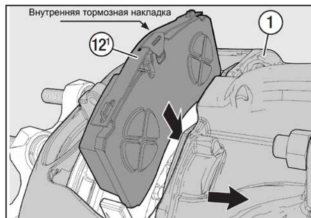
6.2.4a - Установить внутреннюю тормозную наладку (ST7)
