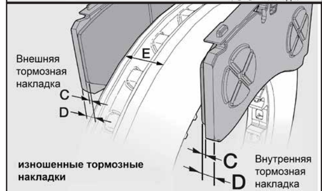
5.1.3 - Размеры тормозной накладки и тормозного диска
