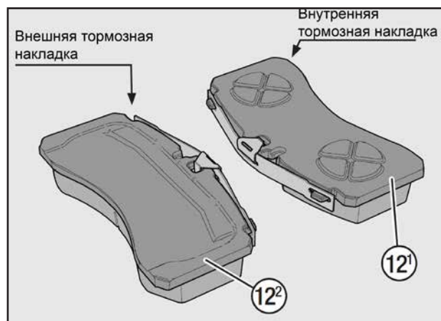
6.2 - Внутренняя и внешняя тормозные накладки имеют различную конструкцию
