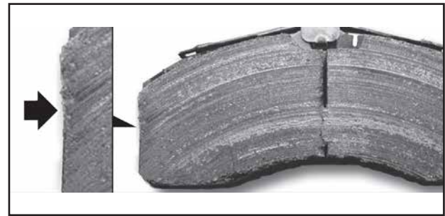
5.1.1 - Тормозная накладка с допустимыми незначительными сколами
