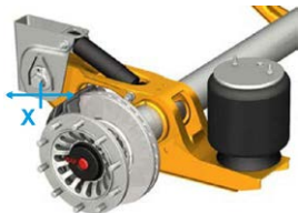
Obr. 1: Kloubová pružnost: x = \pm 14 mm, celkem 28 mm
