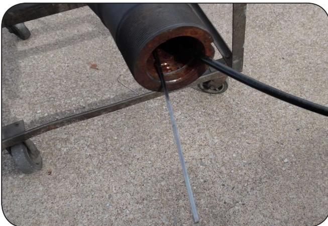
**NOTA:** Podría ser necesario usar una varilla metálica de 1/8" para ayudar a hacer pasar la tubería de 1/8" a través del eje (**Figura 7**).
