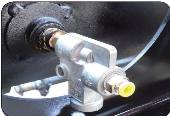
10. Conecte cada tubería de aire del eje junto con un conector en T de compresión o de presión (**Figura 15**, página 8). Asegure apretando con la mano el conector de compresión más 1/2 vuelta adicional (**Figura 15**, página 8).
