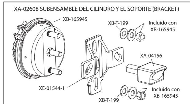
**PH-419RA11** – El conjunto completo incluye gancho de clavija, émbolo, cámara de aire y soporte de montaje.
