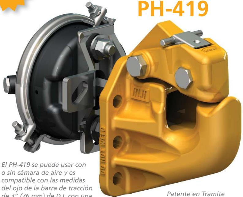
*El PH-419 se puede usar con o sin cámara de aire y es compatible con las medidas del ojo de la barra de tracción de 3" (76 mm) de D.I. con una sección transversal de 1.63" (41.5 mm).*
