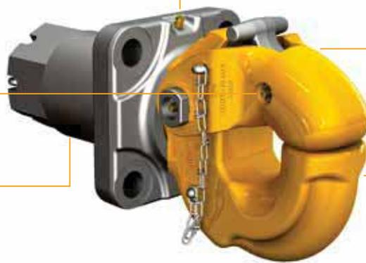
O engate em liga de aço fundido é tratado termicamente para aumentar a resistência e durabilidade
