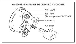
PH-405RA11 – El conjunto completo incluye el gancho de émbolo, cámara de aire y soporte de montaje.
