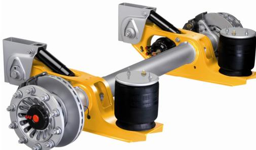
Luftfederbälge mit gleichen technischen Daten wie Balgdurchmesser und Achshub (siehe unten stehende Tabelle) sind im Ersatzfall unabhängig von der Ausführung des Tauchkolbens voll austauschbar.
