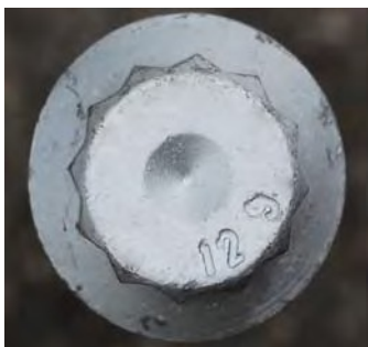
Oryginalna śruba SAF-HOLLAND o twardości 12,9
