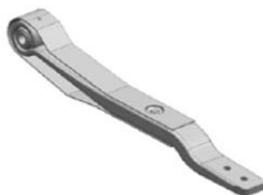
Einblatt-Führungslenker 100 x 52 für Baureihen U/O
